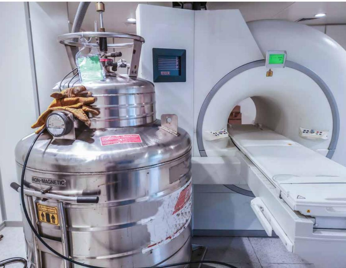
Normalsiedetemperatur ( $< -269^{\circ}\text{C}$ ) auftritt: Beim hierzu nötigen Abpumpen kommt es nach wenigen Betriebsstunden zu einer Blockade des Heliumflusses. Die erforderliche Messtemperatur kann nicht mehr gehalten werden. Aufwendige Versuchsreihen müssen deshalb komplett neu aufgesetzt werden – ein erheblicher Zeit-, Kosten- und Frustrationsfaktor. „Das hat zum Teil zu irrwitzigen
