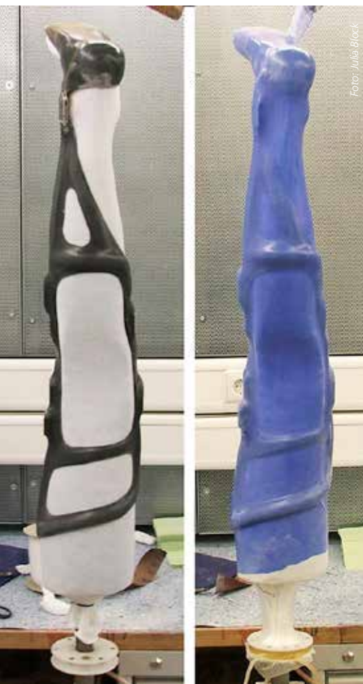
Rahmenkonstruktion und Acrylharzguss: Auf dem Gipsmodell eines Probanden wird dessen Orthese mithilfe der Kohlefaserverbundtechnik angefertigt.
