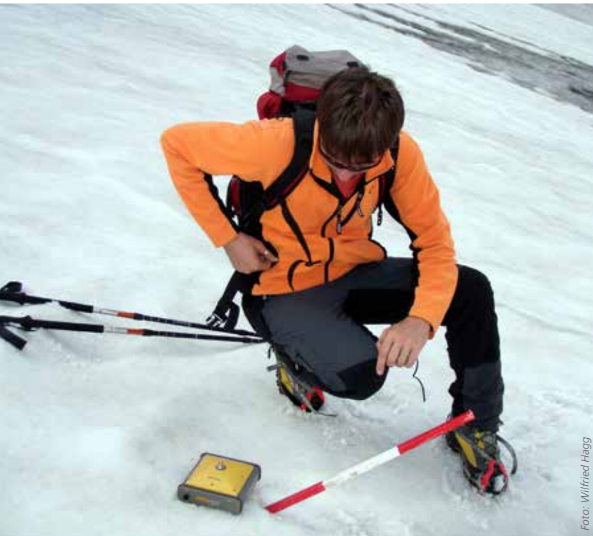
Oben links: Messungen am Blaueis, dem nördlichsten Gletscher der Alpen, mit Laser-Tachymeter. Oben rechts: Einmessung eines Schmelzpegels und Radarmessung (unten) am Lupogletscher.
