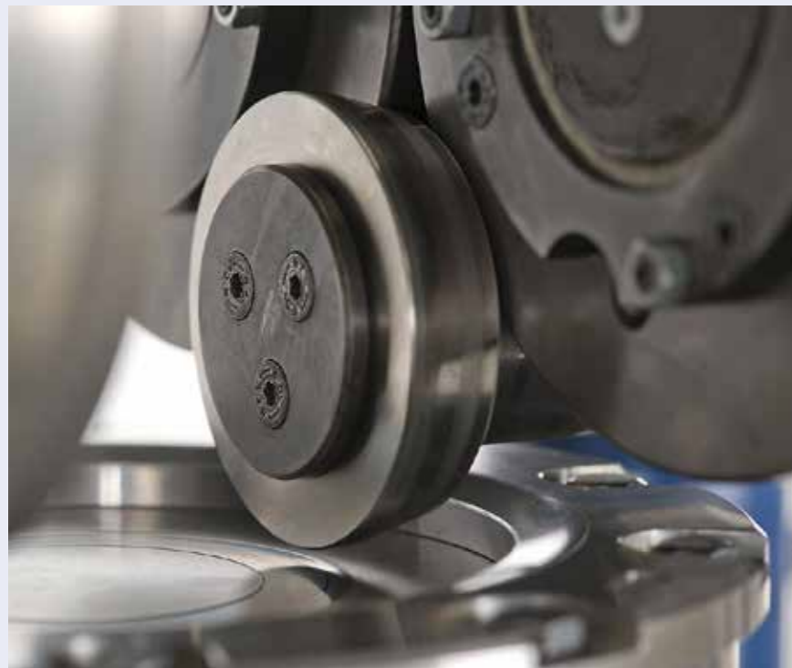
Oben: Konzentrierte Arbeit an einer flexiblen Walzanlage. Unten: Beim Walzen wird das rotierende Werkstück so bearbeitet, dass das Material „prozessangepasst vorverteilt“ wird. Formeinsätze im Werkzeug machen es möglich, ganz unterschiedliche Geometrien zu erschaffen.
