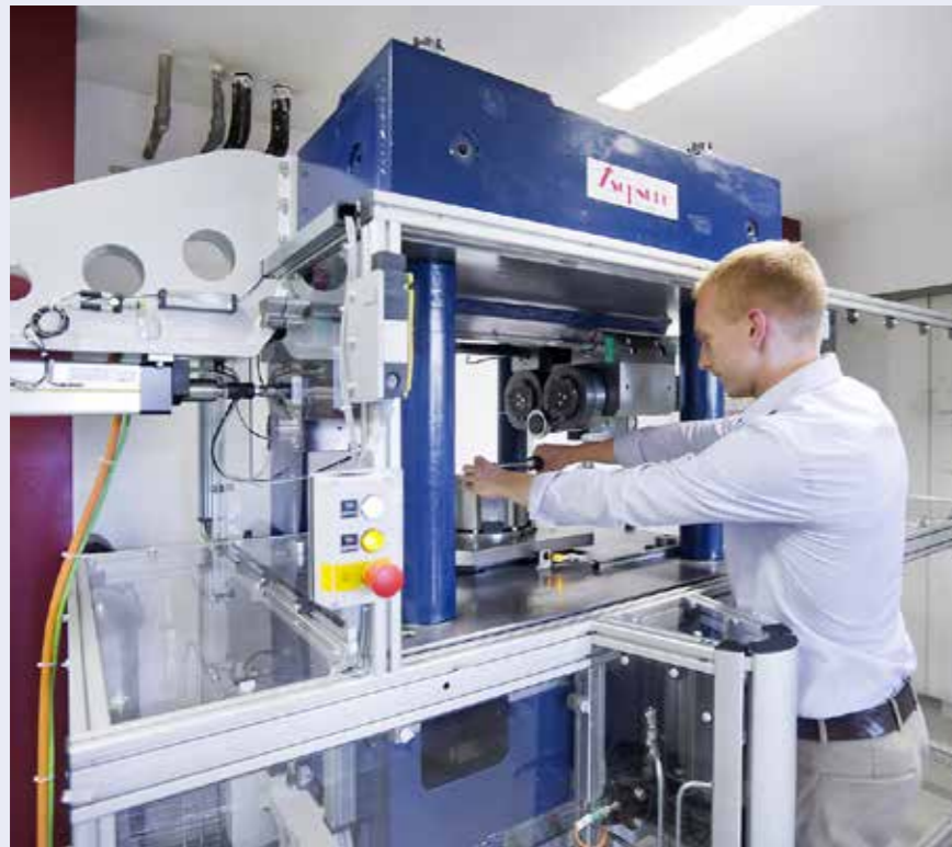
Oben: Konzentrierte Arbeit an einer flexiblen Walzanlage. Unten: Beim Walzen wird das rotierende Werkstück so bearbeitet, dass das Material „prozessangepasst vorverteilt“ wird. Formeinsätze im Werkzeug machen es möglich, ganz unterschiedliche Geometrien zu erschaffen.
