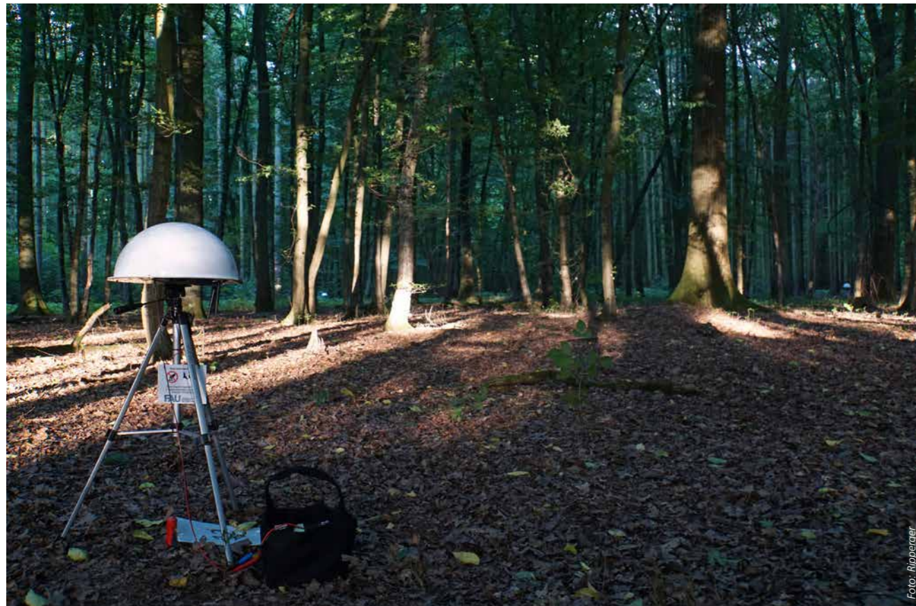
Um die Flugbahnen der Fledermäuse aufzuzeichnen – hier im oberfränkischen Forchheimer Wald –, nutzen die Forscher Tracking-Stationen am Boden, die automatisiert und hochauflösend die Bewegungsdaten der Tiere verarbeiten.
